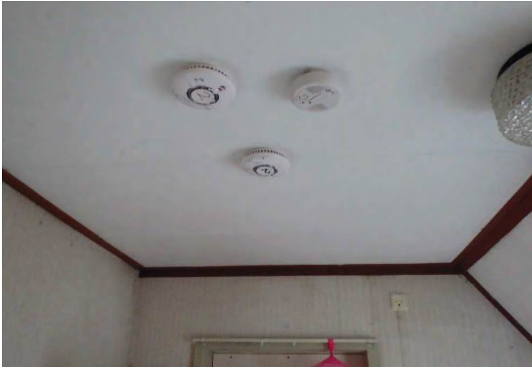
Afbeelding 11: Optische en thermische melders in het experiment
