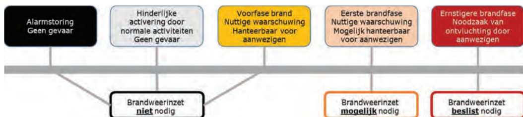
Figuur 5: Detectie en alarmeringen door rookmelders (Ahrens, 2011b)
