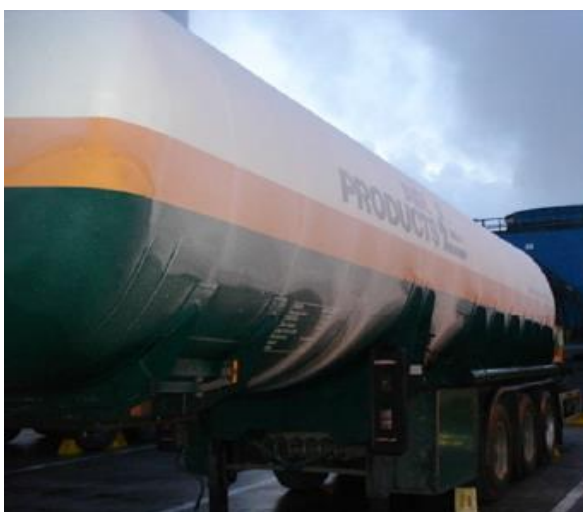
Afbeelding 5.16 Beschadiging isolatie is te herkennen aan ijsvorming aan de buitenkant
