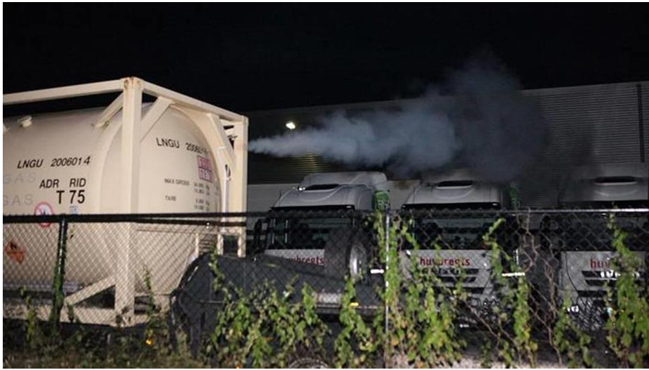
Afbeelding 8.3 Afblaasventiel in werking (vorming BOG) = normaal proces
