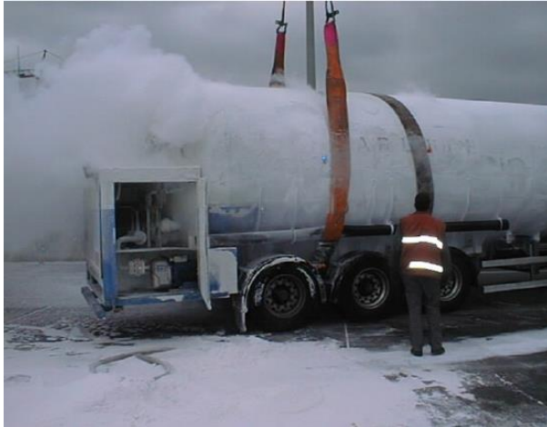
Afbeelding 5.17 Vrijkomen van perliet (wit poeder op de grond) en snel verdampende vloeibare fase (vormen van witte nevel) van een cryogeen gas
