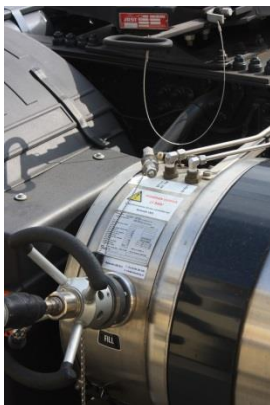
Aansluiting aflever slang op tank
