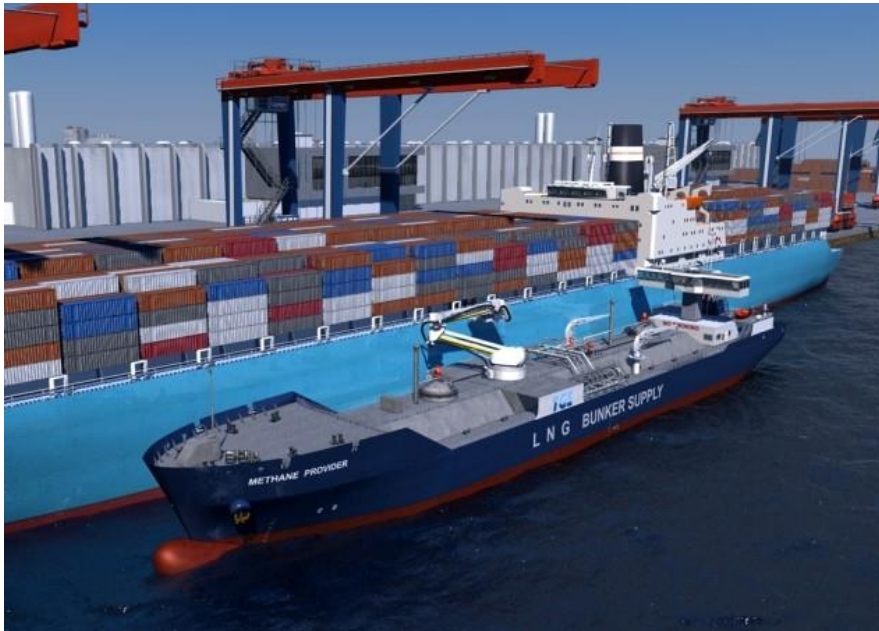
Afbeelding 5.4 Binnenvaart LNG-bunkerschip die een op LNG varende zee containerschip bunkert met LNG
