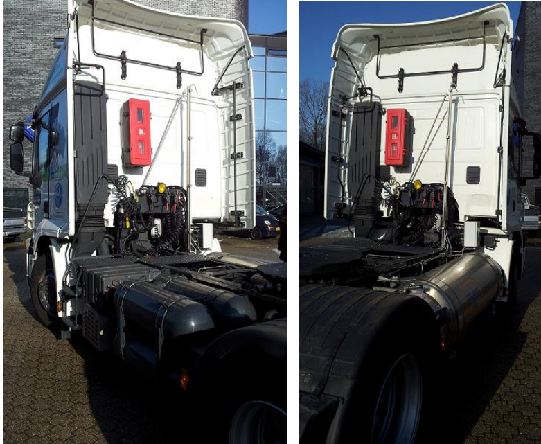
Afbeelding 6.6 Gecombineerd gebruik CNG (links) en LNG (rechts) als brandstof in dezelfde trekker
