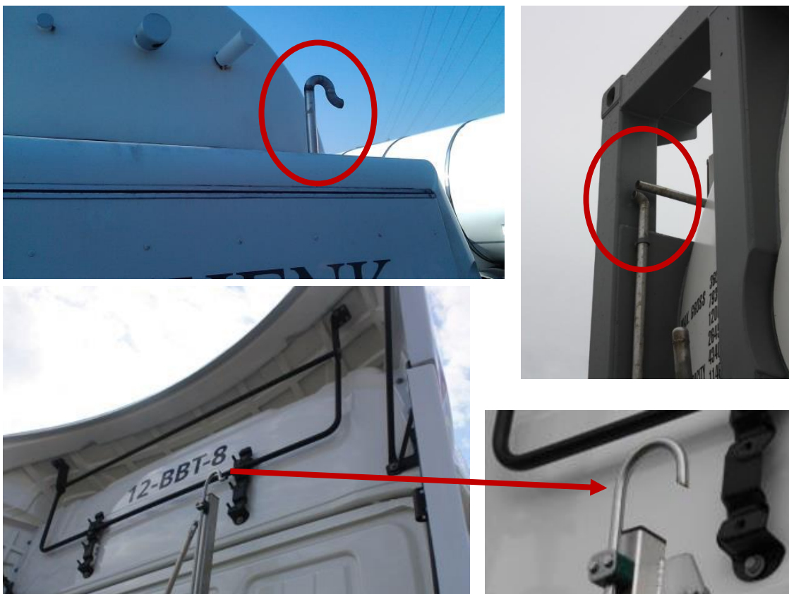
Afbeelding 6.3 Verschillende uitvoeringen van afblaaspijpen (o.a. bij spoiler cabine)
