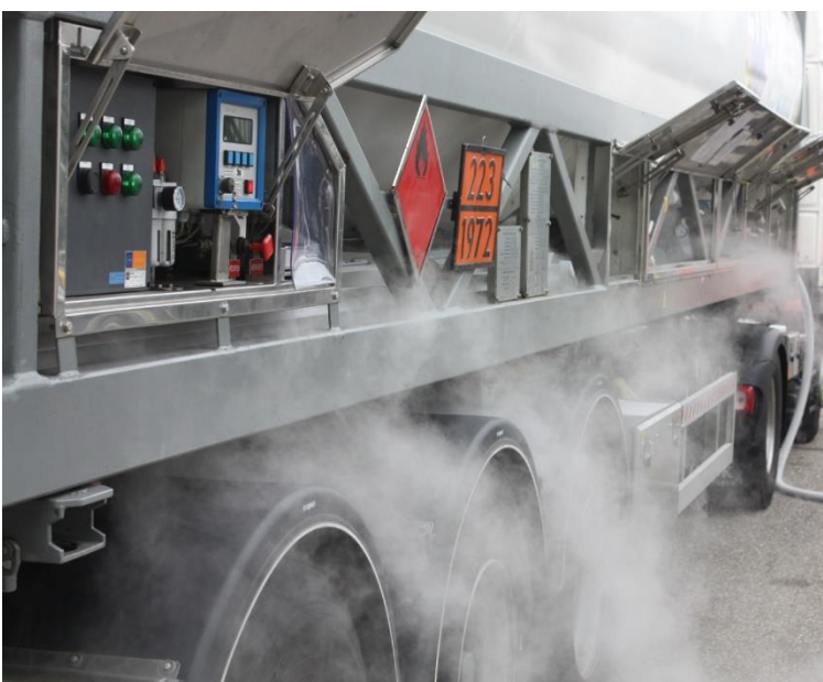
Afbeelding 7.2 Lossen van LNG met condensvorming
