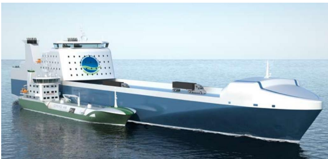
Afbeelding 6.7 Schip dat LNG gebruikt als brandstof wordt getankt vanuit een LNG-bunkerschip
