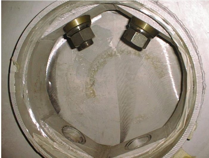
Afbeelding 5.14 Vergroting van het fixeerpunt met de bevestiging van de bovenste twee trekstangen; in de normale situatie zijn er vier trekstangen bevestigd
