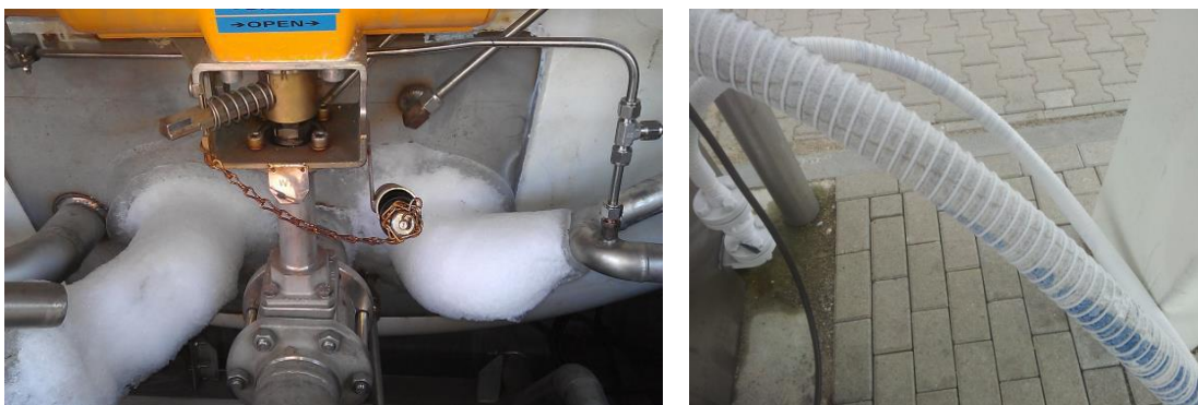
Afbeelding 7.3 IJsvorming op slangen tijdens het lossen
