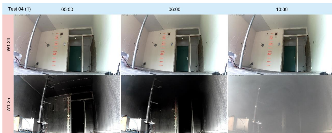
Figuur 3.27 Rook in woning 1.24 en 1.25 tijdens test 4 van variant 1
