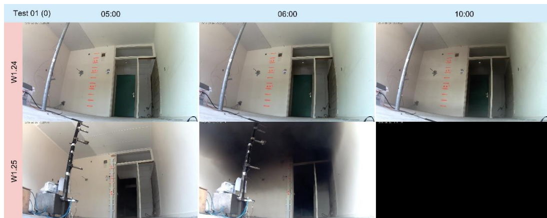
Figuur 3.26 Rook in woning 1.24 en 1.25 tijdens test 1 van variant 0
