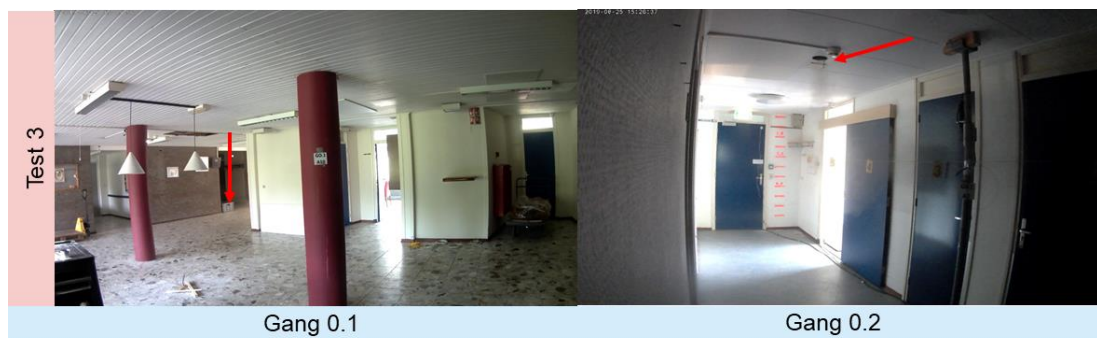
Figuur 3.22 Rookverspreiding naar de begane grond tijdens test 3 van variant 0
