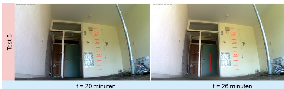
Figuur 3.30 Toevoer van zichtbare rook in woning 1.20 als gevolg van de brandweerinzet tijdens test 5 van variant 0
