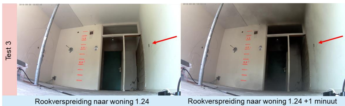
Figuur 3.10 Rookverspreiding naar woning 1.24 tijdens test 3 van variant 0
