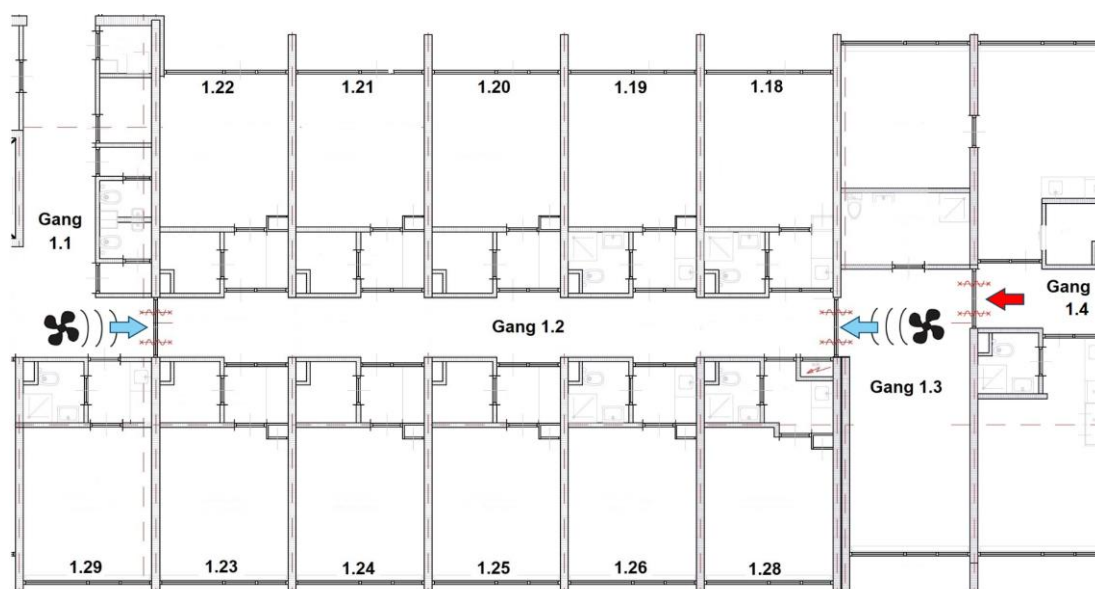
Figuur 2.9 Aanvalsweg en locatie van de ventilatoren
