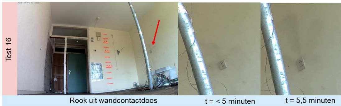
Figuur 3.8 Rook uit een wandcontactdoos in de wand van woning 1.20 tijdens test 16 van variant 1
