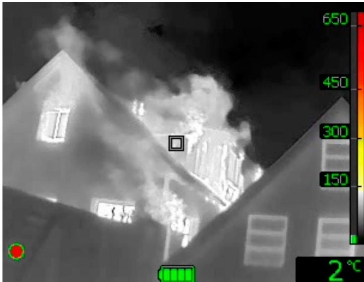
Afbeelding 2.4 Beeld warmtebeeldcamera achterzijde met voordeur open
