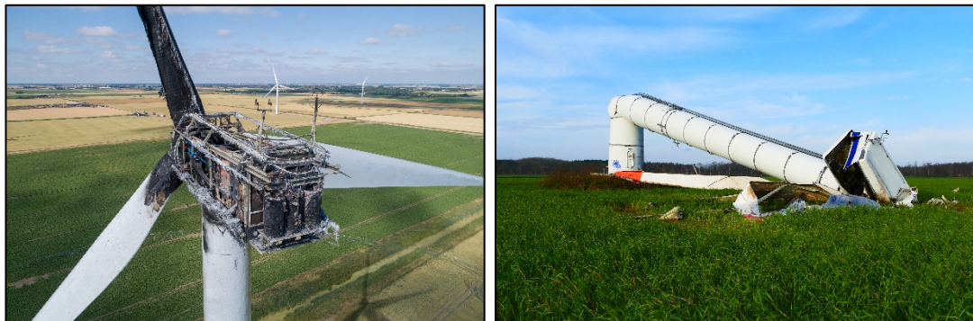
Figuur 5.1 Links: gondel die door blikseminslag in brand is geraakt. Rechts: mast die door een storm geknakt is
