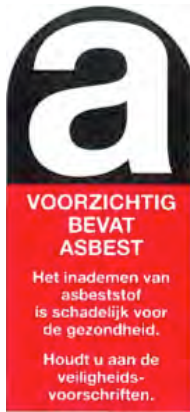
Afbeelding 3.2 Aanduiding asbest (NB: Als het gaat om blauwe asbest, wordt de aanduiding 'bevat asbest' van de standaardtekst vervangen door 'bevat crodicoliet/blauwe asbest')
