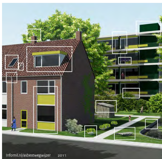
Afbeelding 2.6 Asbesttoepassingen buiten een woning
