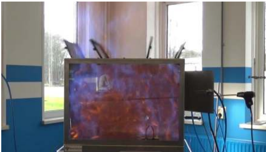
Test 4: Ontbranding bij 20 sec stikstof
