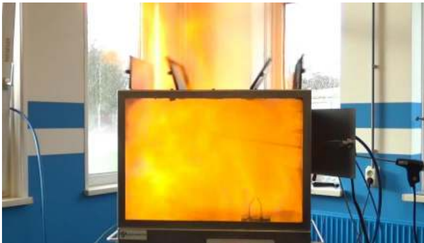
Test 10: Ontbranding bij 120 sec nevel
