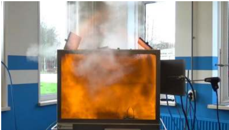
Test 12: Ontbranding bij 300 sec stoom
