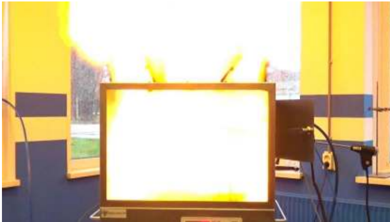
Test 2: Ontbranding bij 10 sec nevel
