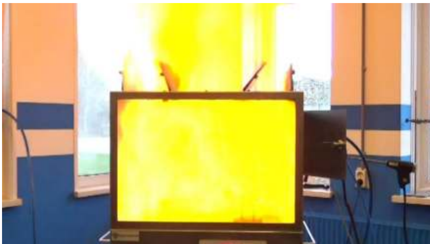
Test 6: Ontbranding bij 30 sec nevel
