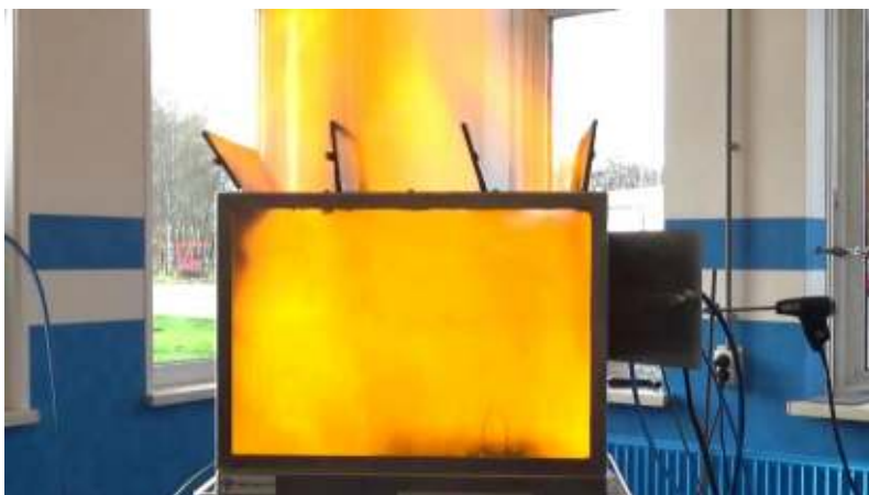
Test 8: Ontbranding bij 60 seconden stoom
