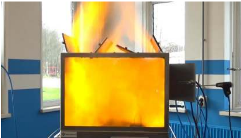
Test 10: Ontbranding bij 120 sec stoom
