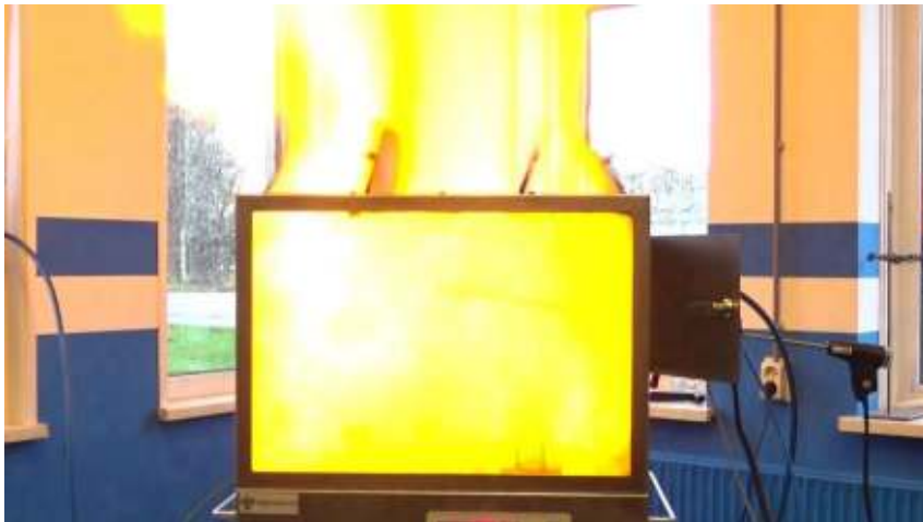
Test 6: Ontbranding bij 30 sec nevel
