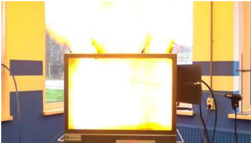
Test 4: Ontbranding bij 20 sec nevel
