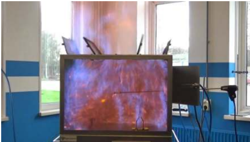
Test 4: Ontbranding bij 20 sec stikstof
