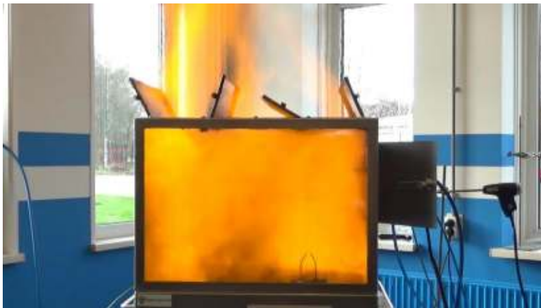
Test 8: Ontbranding bij 60 seconden stoom
