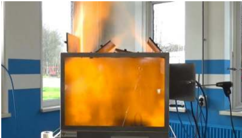
Test 9: Ontbranding bij 120 sec stoom
