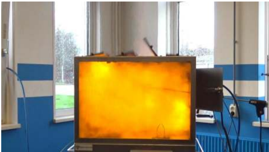
Test 8: Ontbranding bij 60 sec nevel
