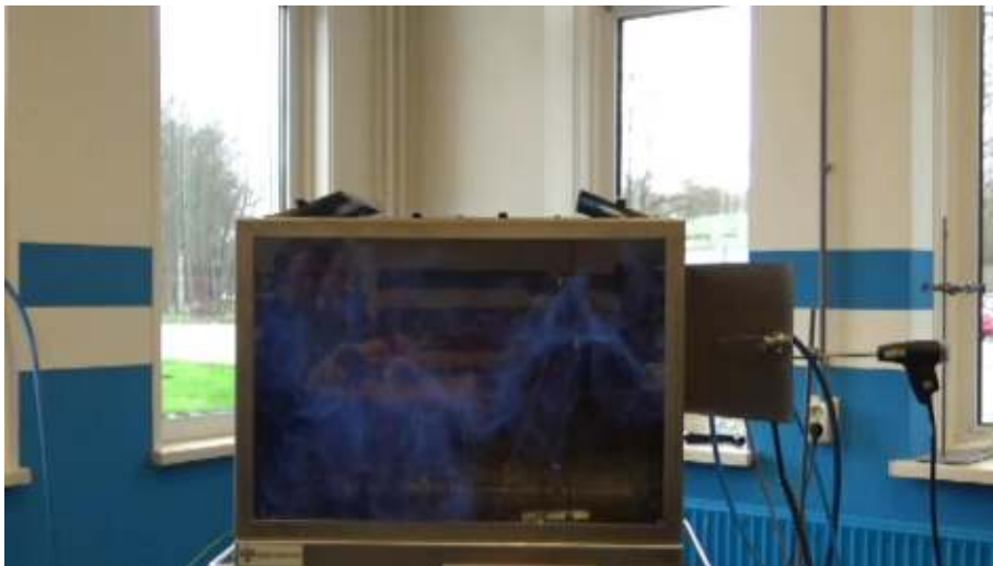
Test 12: Ontbranding bij 180 sec stikstof
