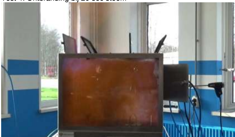
Test 4: Ontbranding bij 20 sec stoom
