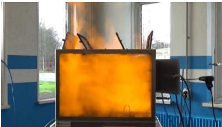
Test 6: Ontbranding bij 30 sec stoom
