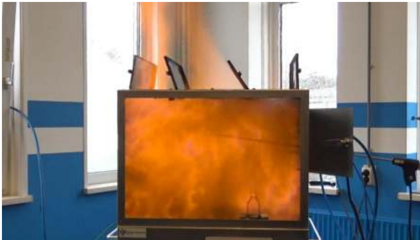
Test 12: Ontbranding bij 300 sec nevel
