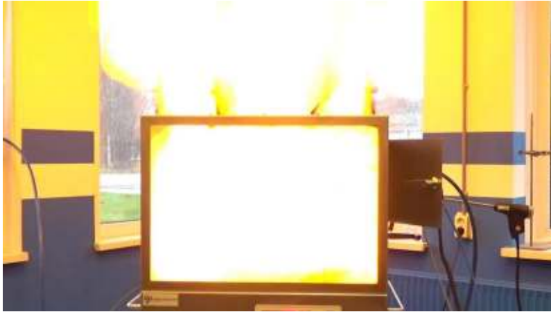
Test 2: Ontbranding bij 10 sec nevel
