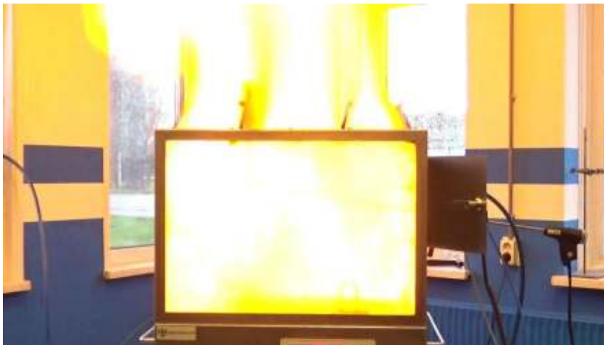
Test 4: Ontbranding bij 20 sec nevel
