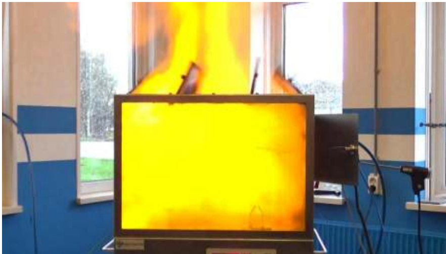
Test 8: Ontbranding bij 60 sec nevel
