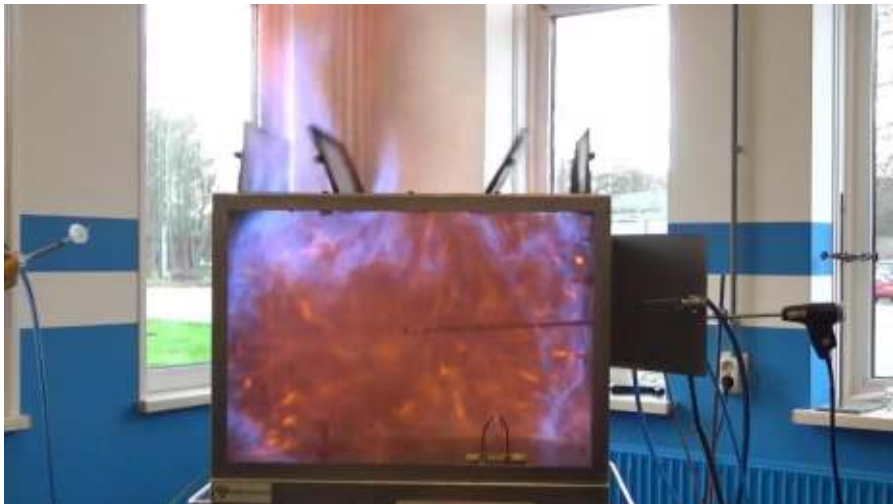
Test 2: Ontbranding bij 10 sec stikstof
