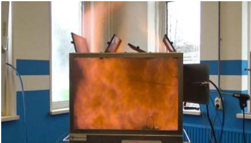
Test 12: Ontbranding bij 300 sec nevel
