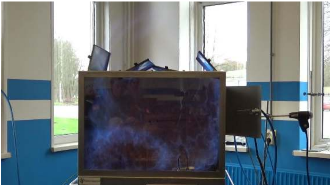
Test 10: Ontbranding bij 120 sec stikstof
