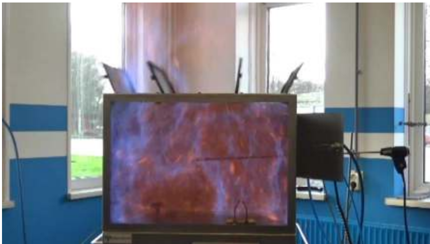
Test 6: Ontbranding bij 30 sec stikstof
