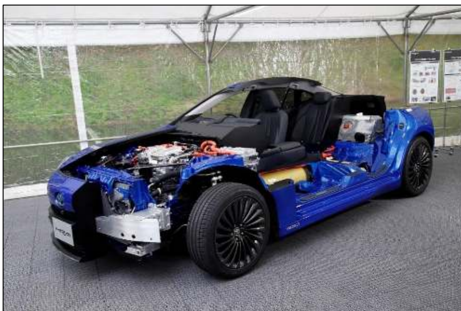
Figuur 1.2 Opengewerkte Toyota Mirai (Newsroom Toyota)
