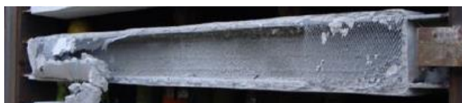
Figuur 37 – Geëgecapsuleerde PBB-constructie na een proefexplosie
