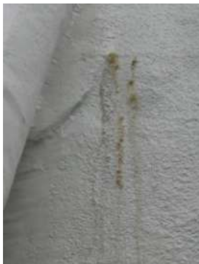
Figuur 12– Afgescheiden zout op epoxy PBB-materiaal
