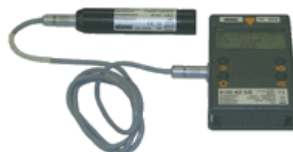
Figuur 7.3 Sonde via sondekabel aangekoppeld
