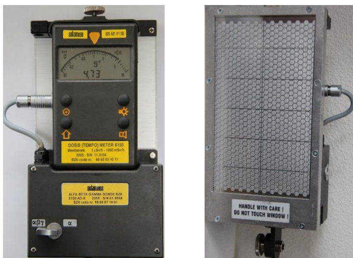
Figuur 7.8 Automesst met AD-k; links de meter in de \alpha\beta\gamma -sonde met aangesloten kabel en rechts de onderzijde van de sonde zonder kap, het meetoppervlak
