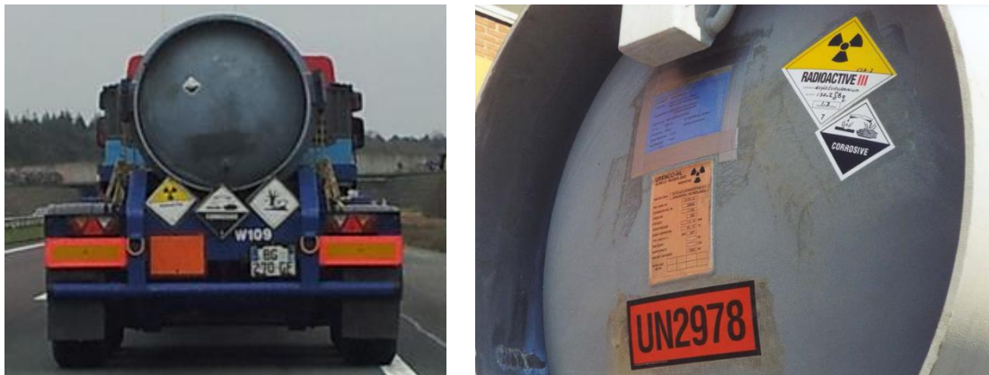
Figuur 8.2 Transport containers met UF_6 , UN 2978
