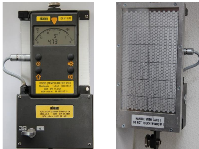
Figuur 7.8 Automess met AD-k; links de meter in de \alpha\beta\gamma -sonde met aangesloten kabel en rechts de onderzijde van de sonde zonder kap, het meetoppervlak.
