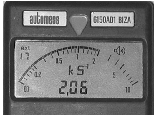
Figuur 7.7 Display met sonde AD-17 met 2,06 \text{ kS}^{-1} = \text{ong. } 2000 \text{ cps} ; in de linkerbovenhoek van het display staat de gebruikte sonde
