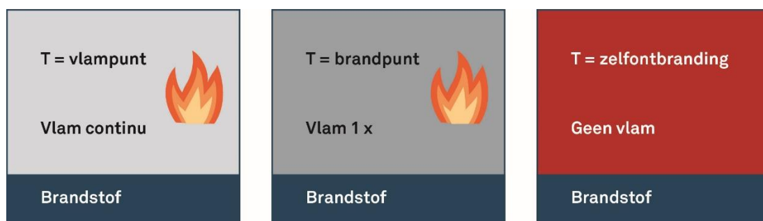
Figuur 2.4 Verschil tussen vlampunt, brandpunt en zelfontbranding
