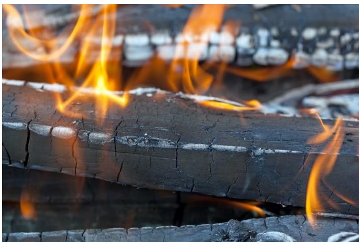
Figuur 4.5 Vorming van een koollaag (Bron: E.J. Huizer)
