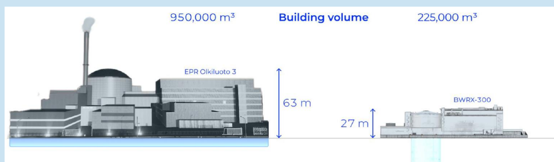
Figuur 8.3 Ontwerp van de BWRX-300, een grote SMR, in verhouding tot de Olkiluoto 3, een conventionele kernreactor met een vermogen van 1600 MW e (bron: ANVS)
