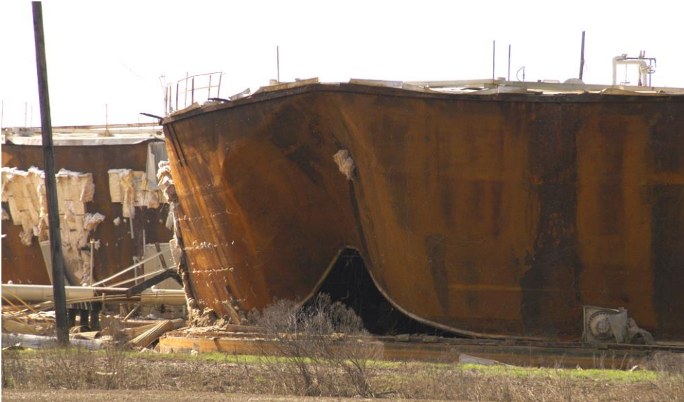
Figuur 6. Van fundament losgekomen atmosferische opslagtank na een orkaan (Foto: M. Nauman, FEMA)
