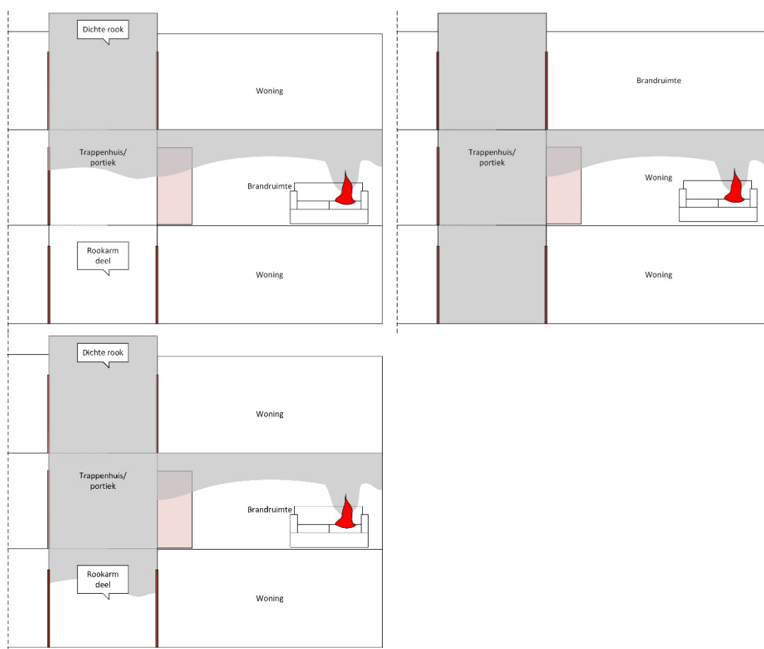
Figuur 2.5 Rookverspreidingsscenario's: [1] linksboven: stratificatie, [2] linksonder: uitgezakte rooklaag, [3] rechtsboven: uniforme menging
