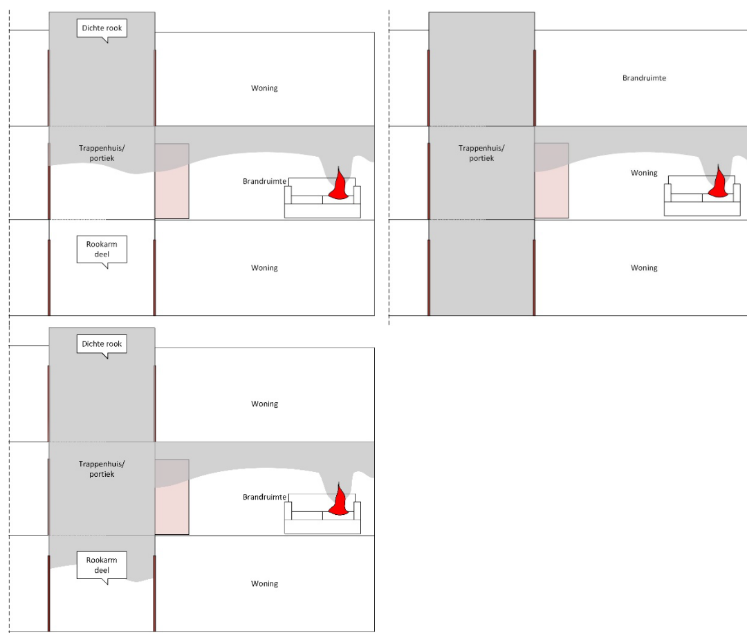
Figuur 5.3 Rookverspreidingsscenario's ([1] linksboven: stratificatie, [2] linksonder: uitgezakte rooklaag, [3] rechtsboven: uniforme menging)
